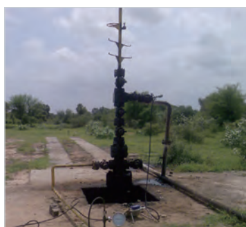
图 7 nVision 参考记录仪从气举井口记录两个压力输入值
