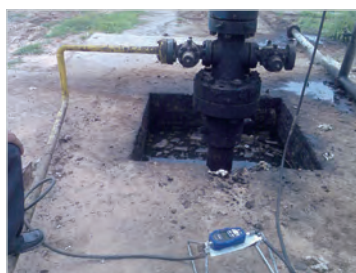
图 6 nVision 参考记录仪从气举井口记录两个压力输入值
