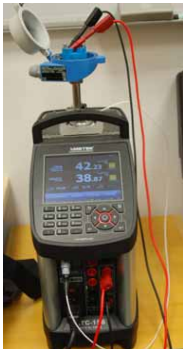
图 8 RTC 校准 TR13 示意图
