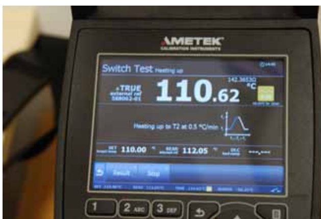
图 10 温度开关校准示例
