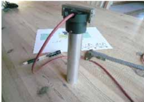
图 16 TS333 特殊校准套管
